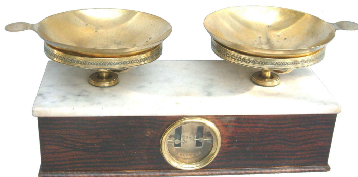
Petite balance-pendule (à l'époque dénommée " balance Roberval lyonnaise "), de marque Béranger & C ie , explicitement datée de 1846 .
