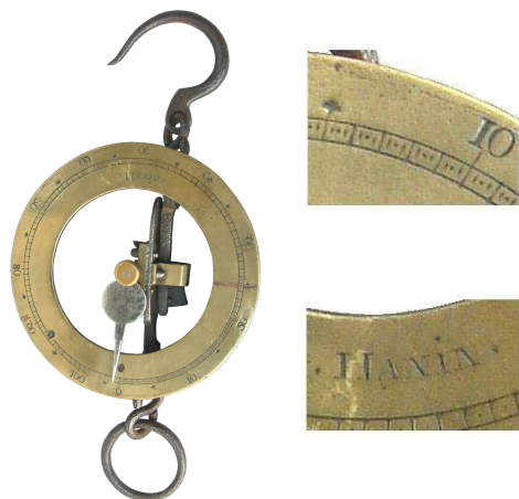
Peson à cadran annulaire, marqué Hanin, datable entre 1765 et 1795.
