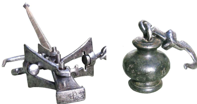
Grande romaine de boucher, en fer forgé, Montpellier, explicitement datée de 1751.
