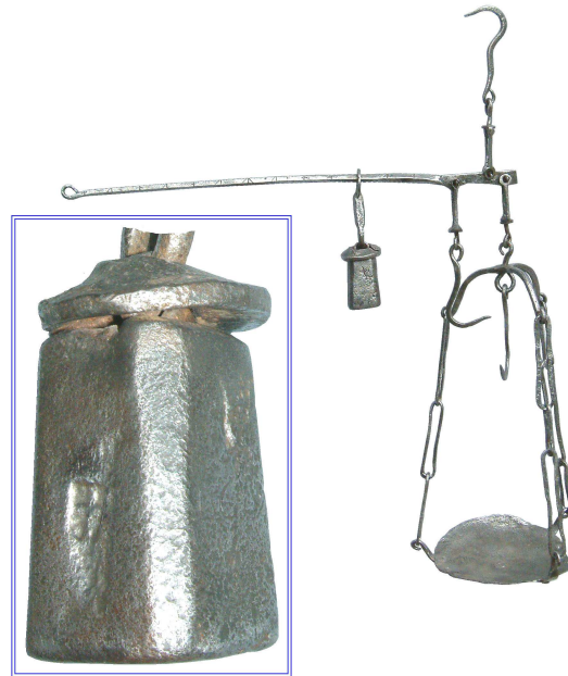
Romaine savoyarde ou piémontaise en fer forgé, explicitement datée de 1619.
