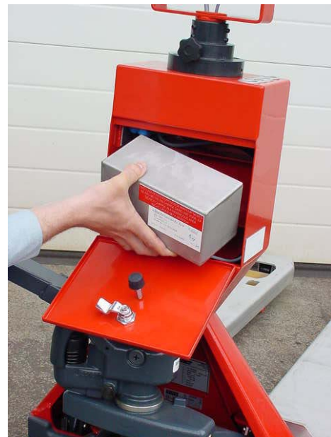
Batterie démontable en zone dangereuse
